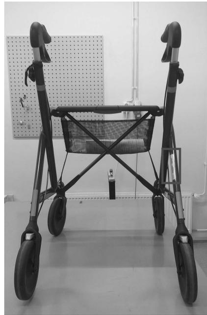
Imagen del andador con ubicación de la etiqueta con información sobre el modelo, fecha de fabricación y n° de serie.
